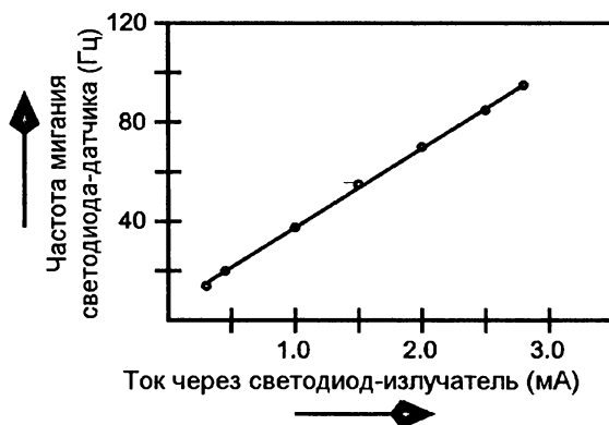
Рис. 5.12. Частота мигания светодиода-датчика в зависимости от интенсивности падающего света
