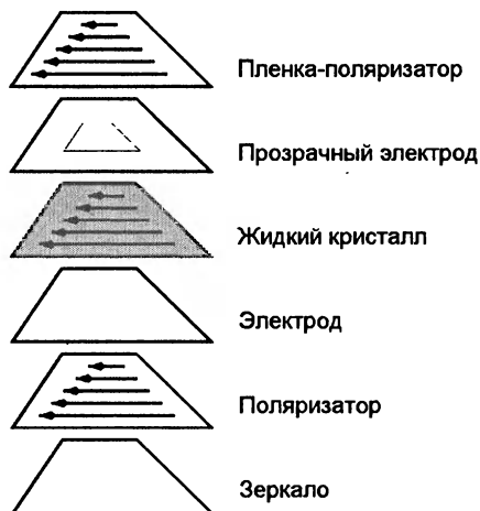
Рис. 4.3. Слои отражающего LCD в поляризованном состоянии кристаллов
