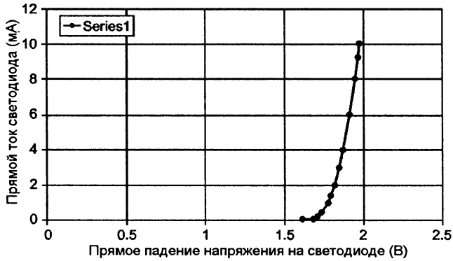
Рис. 2.3. Прямая ветвь вольт-амперной характеристики красного светодиода
