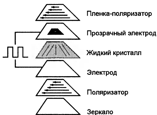
Рис. 4.2. Слои отражающего LCD в нормальном состоянии кристаллов
