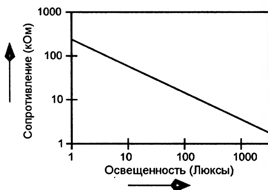
Рис. 5.4. Зависимость сопротивления фоторезистора от интенсивности света
